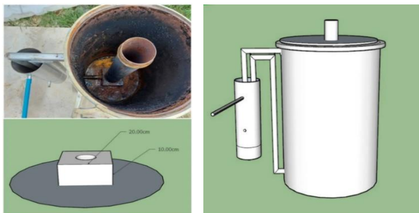
ภาพที่ 2 แบบเตาเผาไปโอชาร์แบบตั้ง ขนาดบรรจุ 250 ลิตร
