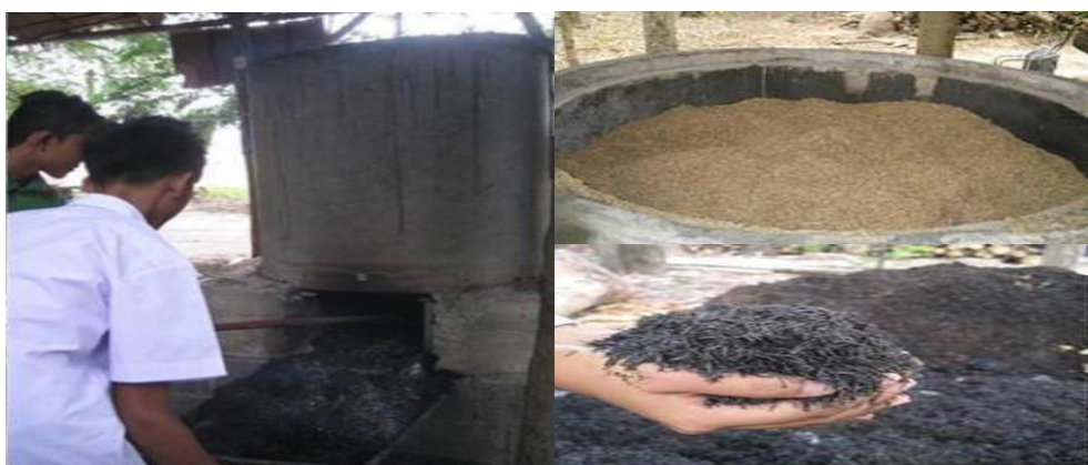
ภาพที่ 10 ลักษณะเตาเผาแบบท่อปูนสำหรับการผลิตไบโอชาร์แกลบ
