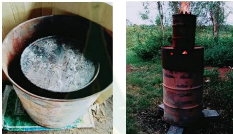
ภาพที่ 4 แบบเตาเผาเตา 2 ชั้น โดยใช้ถัง 100 ลิตร วางอยู่ด้านในถัง 200 ลิตร
