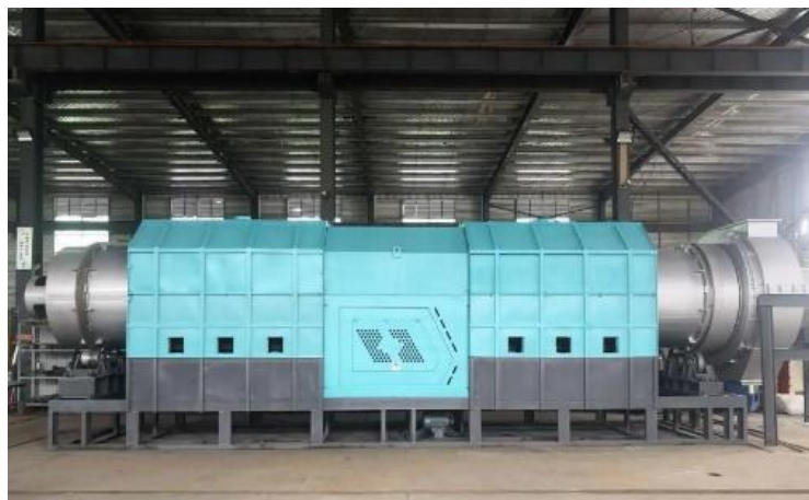
ภาพที่ 7 แบบเตาเผาไบโอชาร์ขนาดอุตสาหกรรม
