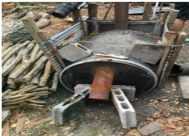
ภาพที่ 5 แบบเตาเผาเตาชั้นเดียวแนวนอน โดยใช้ถัง 200 ลิตร
