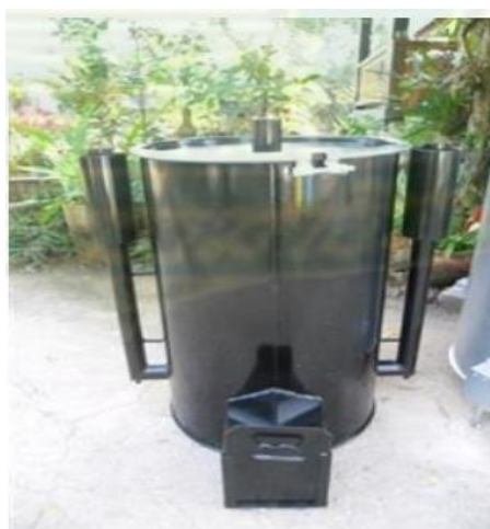
ภาพที่ 3 แบบเตาเผาเตาชั้นเดียวแนวตั้ง โดยใช้ถัง 200 ลิตร
